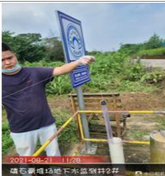
磷石膏堆场地下水监测井 2#
